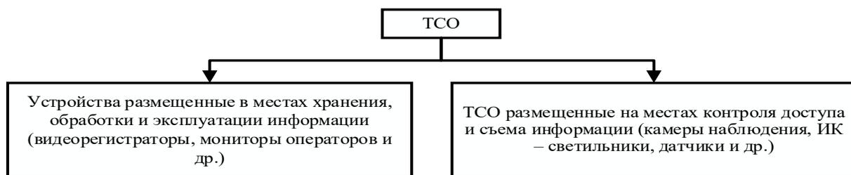
Рис. 3. Классификация устройств ТСО относительно места их размещения.
