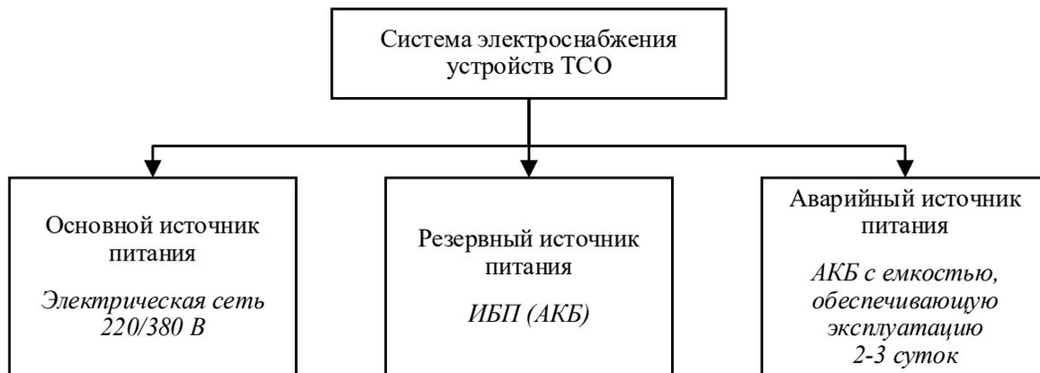
Рис. 1. Система электроснабжения устройств ТСО
