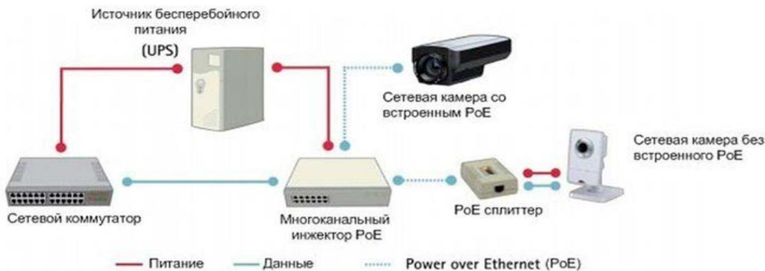
Рис. 2. Схема использования технологии PoE.
