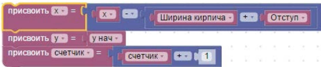
Далее робот перемещается в начальную координату по y, но смещается по x на 1 ряд ниже. При этом Счетчик, а, следовательно, и номер ряда увеличивается на 1.
