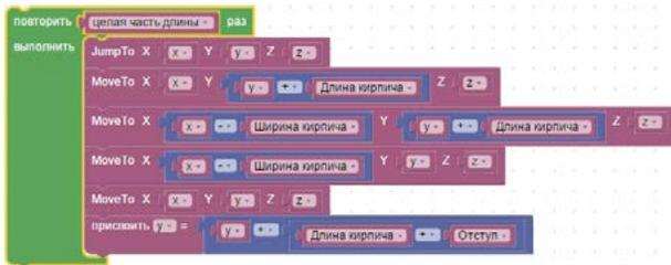
Данный цикл реализует целые кирпичи. Например, при расчете получилось число кирпичей равно 3,8, робот рисует 3 целых кирпича.
