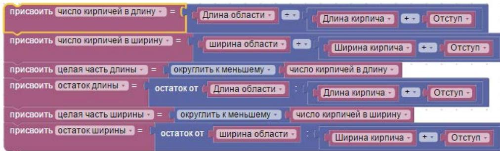
Число кирпичей в длину рассчитывается делением длины области на длину кирпича и отступа. При этом число может получиться целое (с остатком 0) или дробное (с ненулевым остатком). Далее полученное число разделяется на 2 переменные: целую часть и остаток. Поведение робота для каждой из этих переменных будет разное. Аналогично рассчитываются и присваиваются переменные для ширины области.
