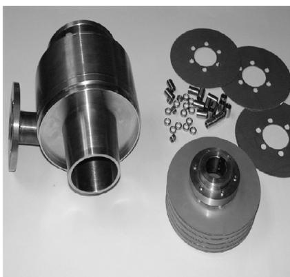
Рис. 1. Составные элементы дискового насоса
