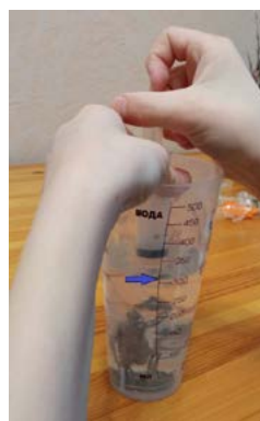
Рис. 15. Мерный стакан с водой и погруженным в нее оловянным солдатиком
