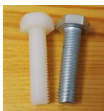
Рис. 6. Два болта одинаковой формы и размера, но из разных материалов
