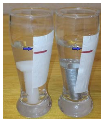
Рис. 8. Два болта из разных материалов, помещенные в одинаковое количество воды
