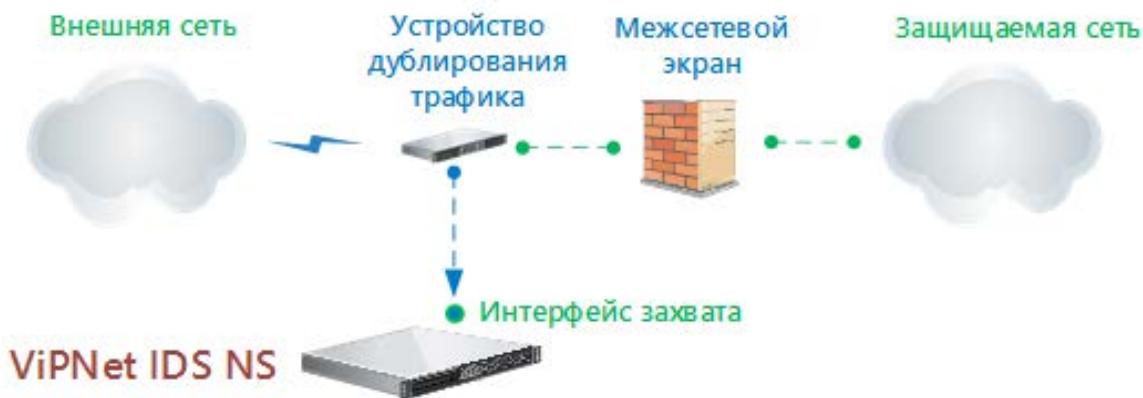
Рис. 1. Расположение IDS с внешней стороны сети за межсетевым экраном
