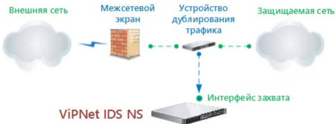
Рис. 2. Расположение IDS с внутренней стороны сети перед межсетевым экраном
